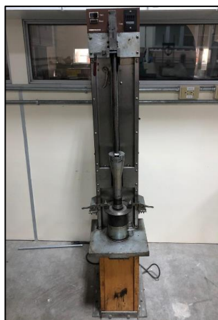
Figura 6 Martillo de compactación, Laboratorio UTPL Fuente: El autor Elaborado por: El autor
