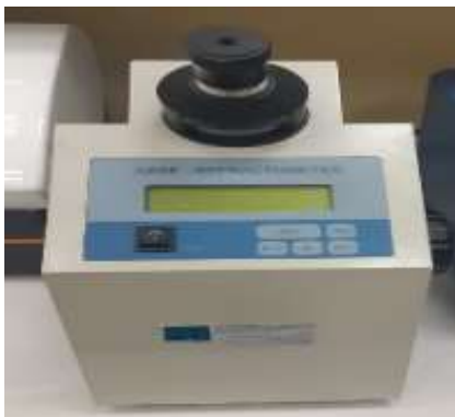
Figura 4. Determinación Índice de refracción del AE de O. vulgare . Fuente: Investigación Experimental Elaborado por: El Autor
