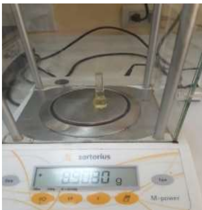
Figura 3. Determinación Densidad Relativa del AE de O. vulgare . Fuente: Investigación Experimental Elaborado por: El Autor
