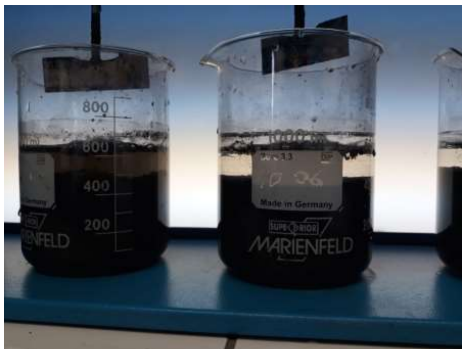
Figura 14. Clarificación de tinta Prueba de Jarras 2 Fuente: Proceso de coagulación y floculación (2018) Elaborado por: Stalin Briggs
