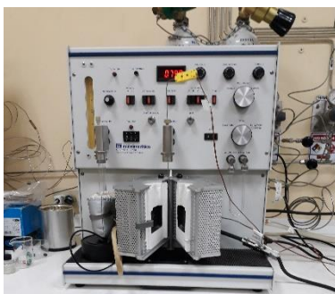
Figura 16. Equipo para medir el área específica Chemisorb 2720
