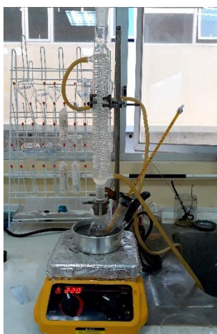
Figura 17. Equipo de reflujo para la reacción de Aceite-Zeolita Fuente: Autora Elaboración: Autora
