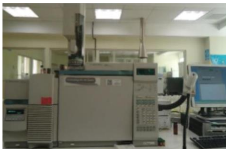
Figura 18. Cromatógrafo de gases acoplado a espectrometría de masas Fuente: Autora Elaboración: Autora
