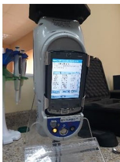
Figura 15. Equipo de Fluorescencia de Rayos X Fuente: Autora Elaboración: Autora
