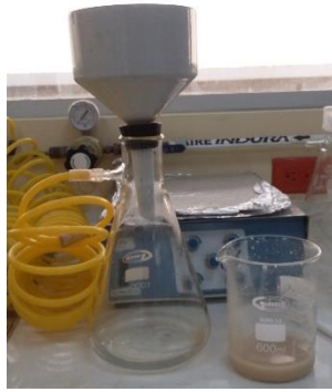
Figura 12. Lavado con agua destilada de la Zeolita intercambiada al vacío. Fuente: Autora Elaboración: Autora
