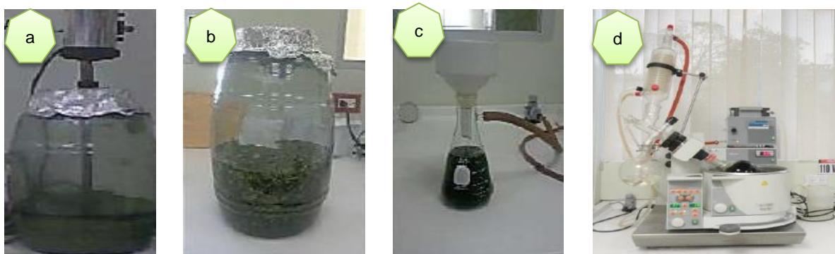
Figura 13. Obtención de Extractos: a) Maceración dinámica, b) Maceración estática, c) Filtración al vacío, d) Rotaevaporación
